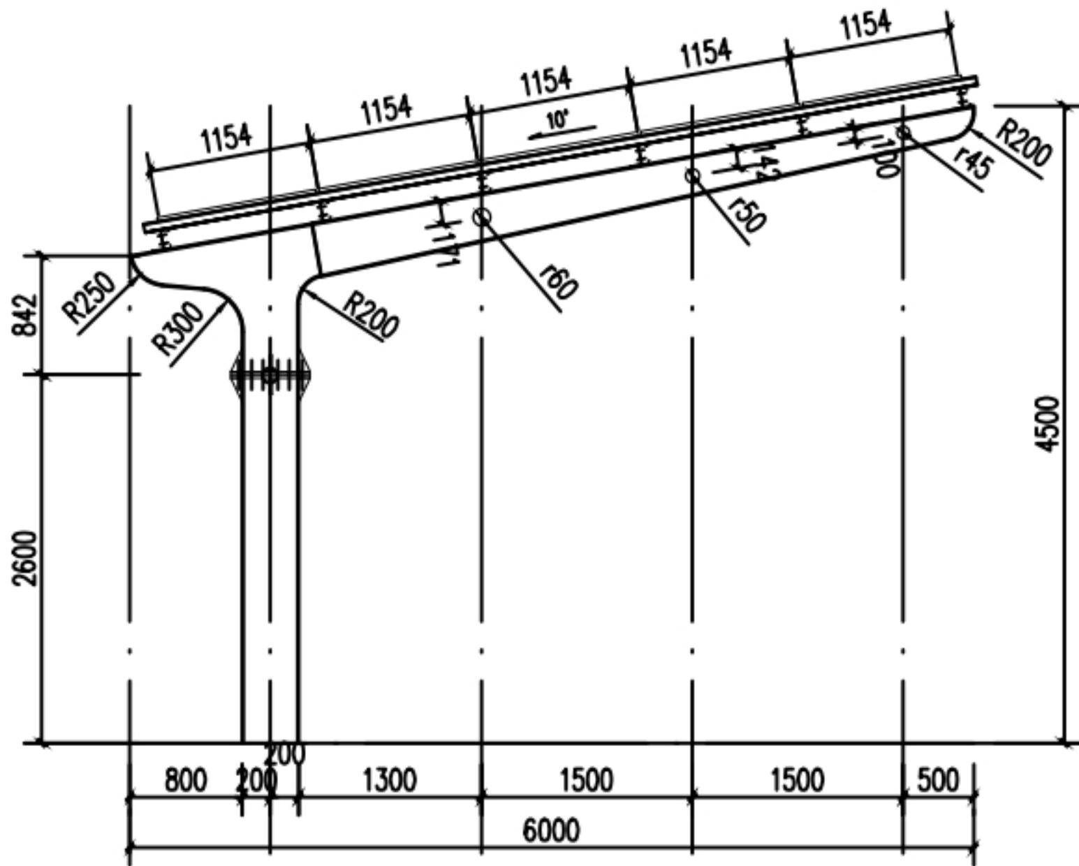
单边光伏车棚建筑侧面图
